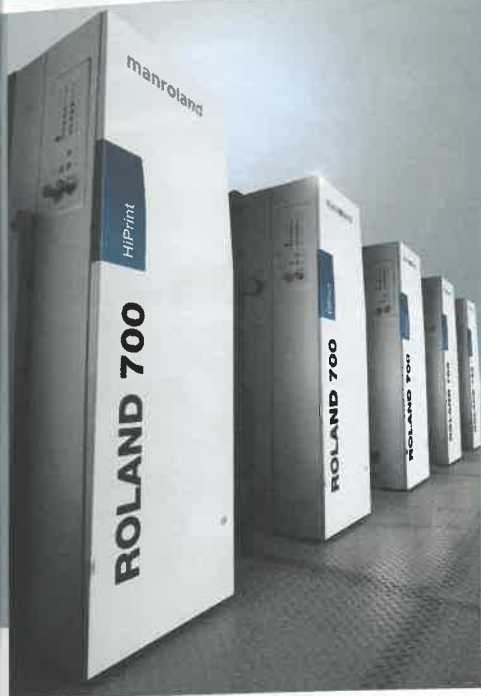
珠海豪迈实业有限公司引进的ROLAND 700 LV五色胶印机配备了ColorPilot自动供墨导控装置及printnetwork印刷系统等增值印刷功能。
