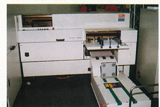
連接DocuTech 6180數碼印刷機的CP Bourg膠裝機
