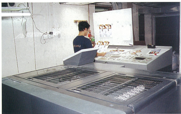
配以 CPC 搖控台及紅外線乾燥器的 SM 52 四色印刷機。
