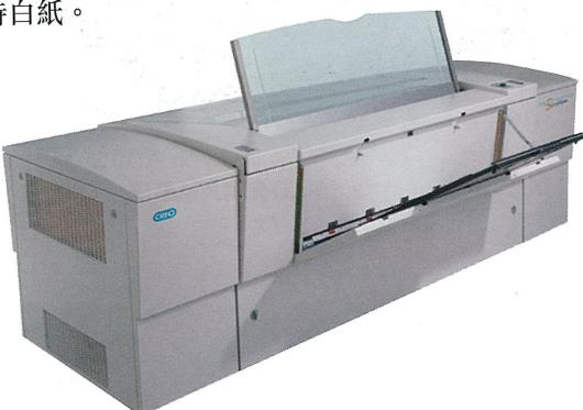
圖十一：Imation Matchprint 數碼印刷網點打稿系統
