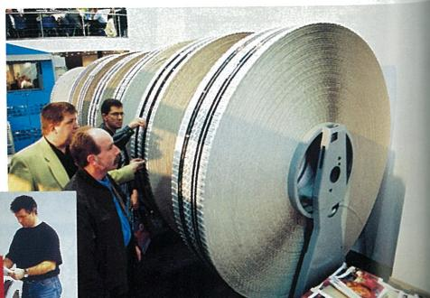
FlexiRoll能配合最高的印刷速度接受印品，並把它們自動卷紮起來，以待插頁時使用
